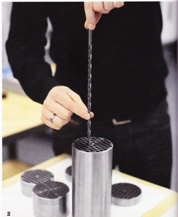
1 In seinem Technologiecenter in Hasle-Rüegsau simuliert und testet Blaser Swisslube neueste Zerspanungstechnologien. 2 Beim Tieflochbohren konnte die Zeit von drei Minuten auf zehn Sekunden pro Loch reduziert werden.
