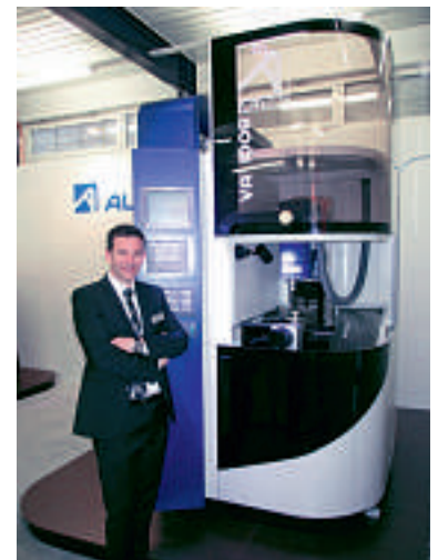
Almac-Geschäftsleiter Philippe Devanthéry: «Das Ultrapräzisions-Bearbeitungszentrum VA 1008 ist für die Fertigung komplexer Mikroteile mit höchsten technologischen Ansprüchen ausgelegt.»
