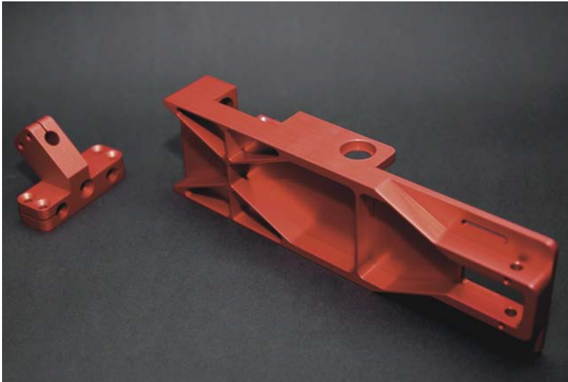
Ausnehmungen und Biodesign-Verstrebungen sorgten für weniger Gewicht und eine gleichzeitig höhere Rigidität der Prüfeinheit.
