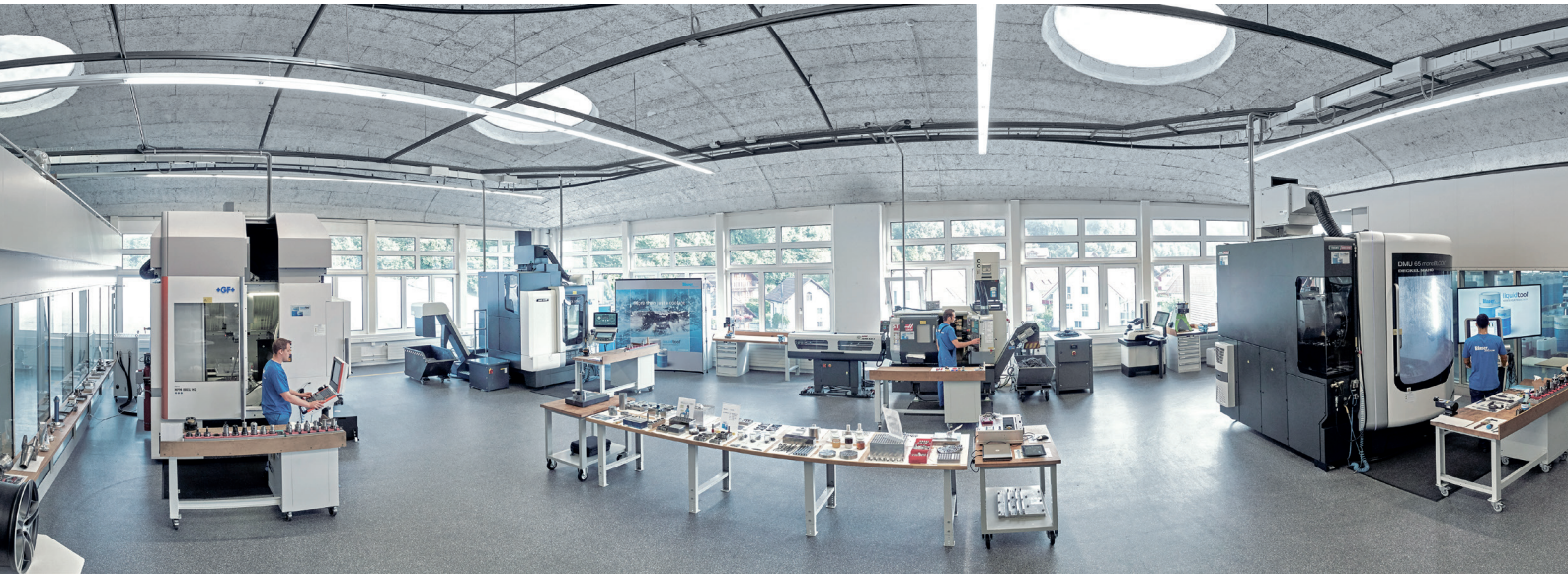
스위스 하슬레 뤼엑사우에 위치한 블라자 스위스루브의 기술센터. 이 곳에서는 고품질의 금속가공유 개발과 절삭유 샘플 분석, 각종 테스트들이 이뤄진다.
