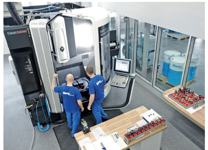
최근 블라자 스위스루브는 고강도 티타늄합금 항공기부품에 관한 프로젝트를 수행했다. 이 프로젝트에는 디엠지모리의 'DMU 65 모노블럭' 장비와 샌드빅의 엔드밀 제품이 사용됐다.
