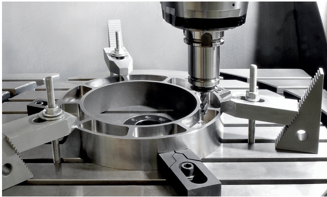
티타늄합금 항공기부품의 가공테스트 모습
